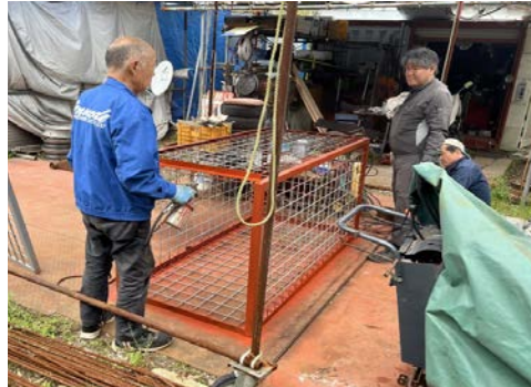
イノシシ捕獲用の箱わなを、補強メンテナンス作業中
