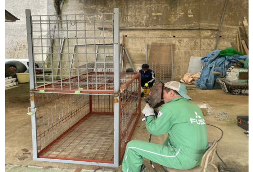
イノシシ捕獲用の箱わなを、補強メンテナンス作業中
